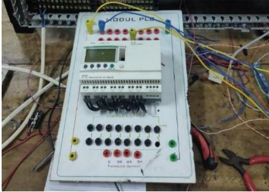
Gambar 8. Pengujian Input/Output *Smart Relay*
